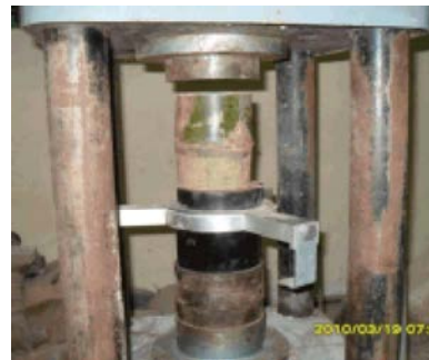
Fig. 3.4: (d) Fresh Non-Reinforcement Bamboo Under Compressive Test
