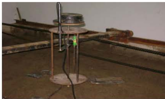
Fig. 2: Paddy soil rheometer
